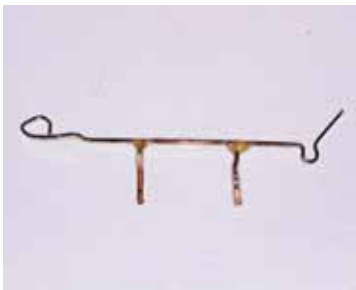
Fig. 12. Reperi con doppio filo di ottone saldato su sezionale.
